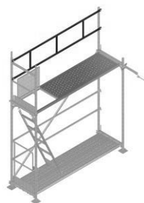
Colocação do guarda costas
